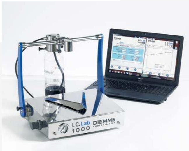
Lo strumento I.C. Lab 1000 è in grado di valutare la filtrabilità sia di liquidi estremamente colmatanti che di liquidi microfiltrati con bassi livelli di colmatazione.
